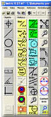
Metric MT a deux niveaux de fonctions supplémentaires : les boutons de la colonne de gauche activent les mesures Point, Ligne, Cercle et Segment de cercle. Les trois boutons en dessous activent les mesures Distance, Angle et Droite d'interpolation. Les premières fonctions marquent les objets et les points de mesure. Les mesures peuvent être alors associées au besoin dans la fenêtre PC (bouton avec l'ordinateur).
